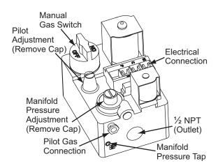
FIGURE 10 - GAS VALVE - FRONT
